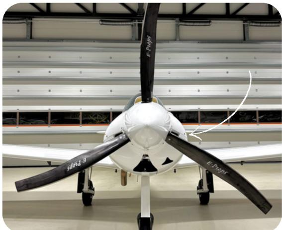
Hélice adaptée aux moteurs Rotax 915iS / 916iS
